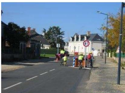
*Mazé (49) : mauvais exemple de chicane sans by-pass pénalisant les cyclistes*
